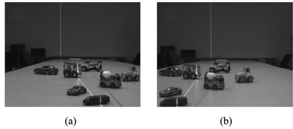
图 12 双目相机采集到的带有激光光栅的图像:
