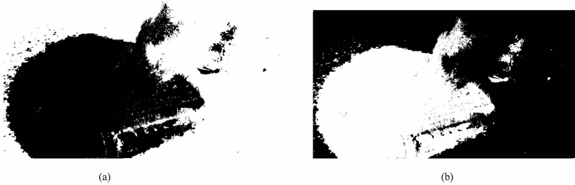
图 2 OTSU 分割的掩膜模板:(a) 暗区域掩膜模板;(b) 明区域掩膜模板
